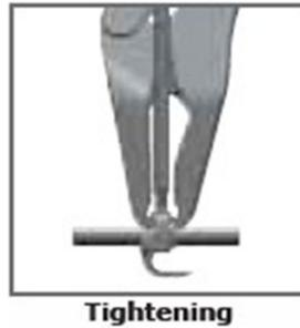
Logo em seguida, o Bastão T-20 (U1-A416) e o cabo limitador de torque é utilizado para atingir um torque 8 Nm ideal (7 Nm para os implantes titânio).
