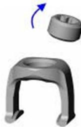
Coloque o Removedor de Clip U1-A422 em um lado do clip de forma de que um dos dentes é colocado no orifício rosqueado.
